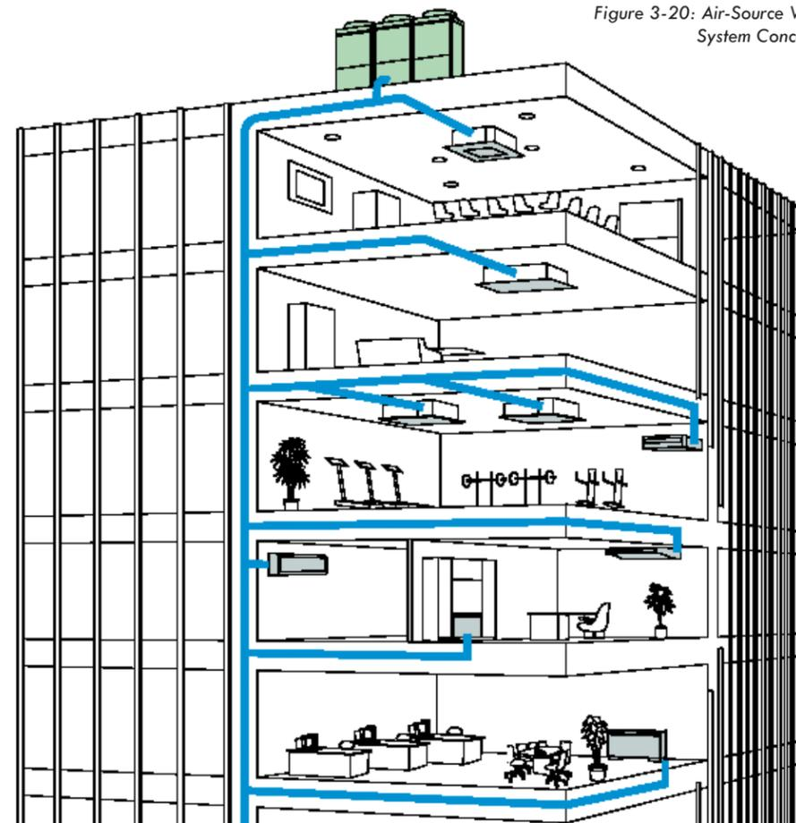
Figure 3-20: Air-Source VRF System Concept
